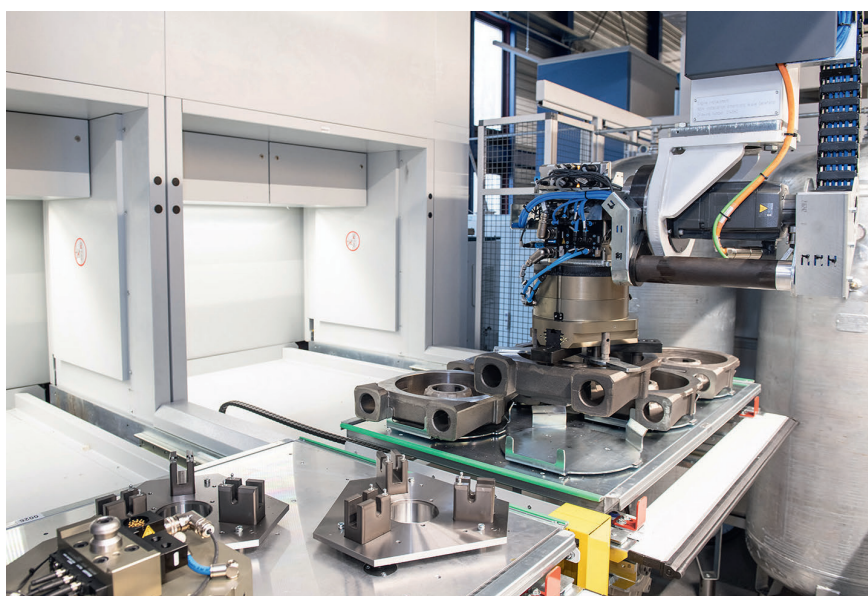
3 Der Portallader kann sowohl Werkstücke als auch Backen und Greifer handhaben
